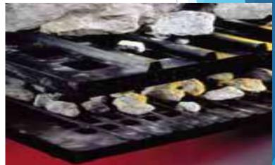
Crivos: formados por chapas metálicas planas ou curvas, perfuradas por um sistema de furos de várias formas e dimensão determinada;
