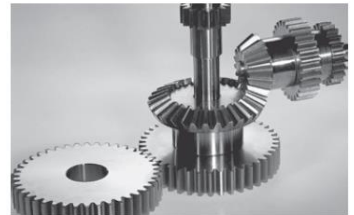
Foto 15.2 Para a engrenagem central que gira em torno de um eixo fixo, a velocidade e a aceleração angulares daquela engrenagem são vetores orientados ao longo do eixo vertical de rotação.
