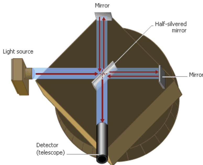
Girando o aparato de 90° não se observa a mudança na posição dos máximos e mínimos dos dois padrões de interferência
