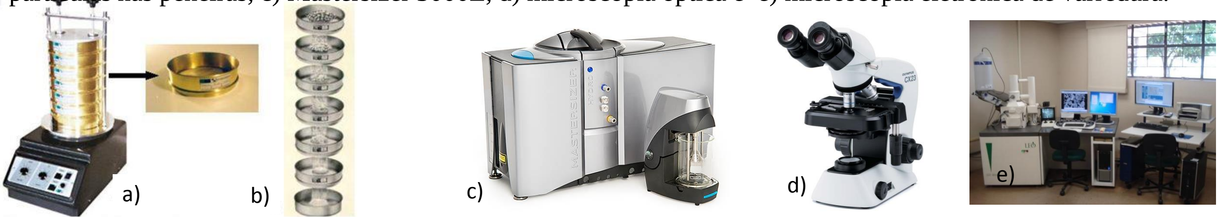
Figura 14 - a) Agitador eletro-magnético e peneiras redondas para análise granulométrica. b) Distribuição das partículas nas peneiras, c) Mastersizer 3000E, d) microscopia óptica e e) microscopia eletrônica de varredura.
