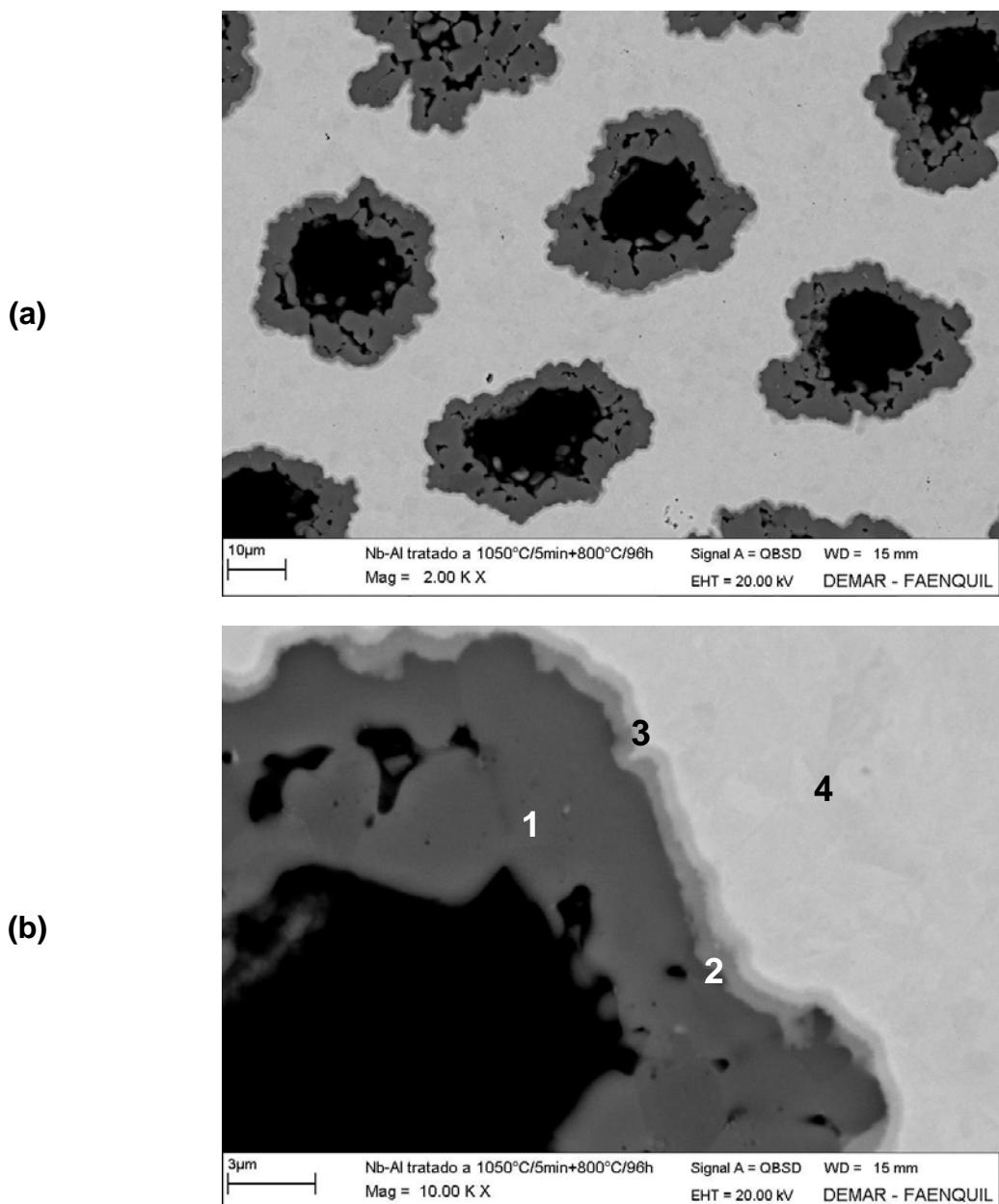
Figura 3. Micrografia obtida em MEV do primeiro embutimento apóas tratamento térmico a 1050°C/5min + 800°C/96horas: (a) região de filamentos, (b) identificação de fases relativas à Tabela II.
