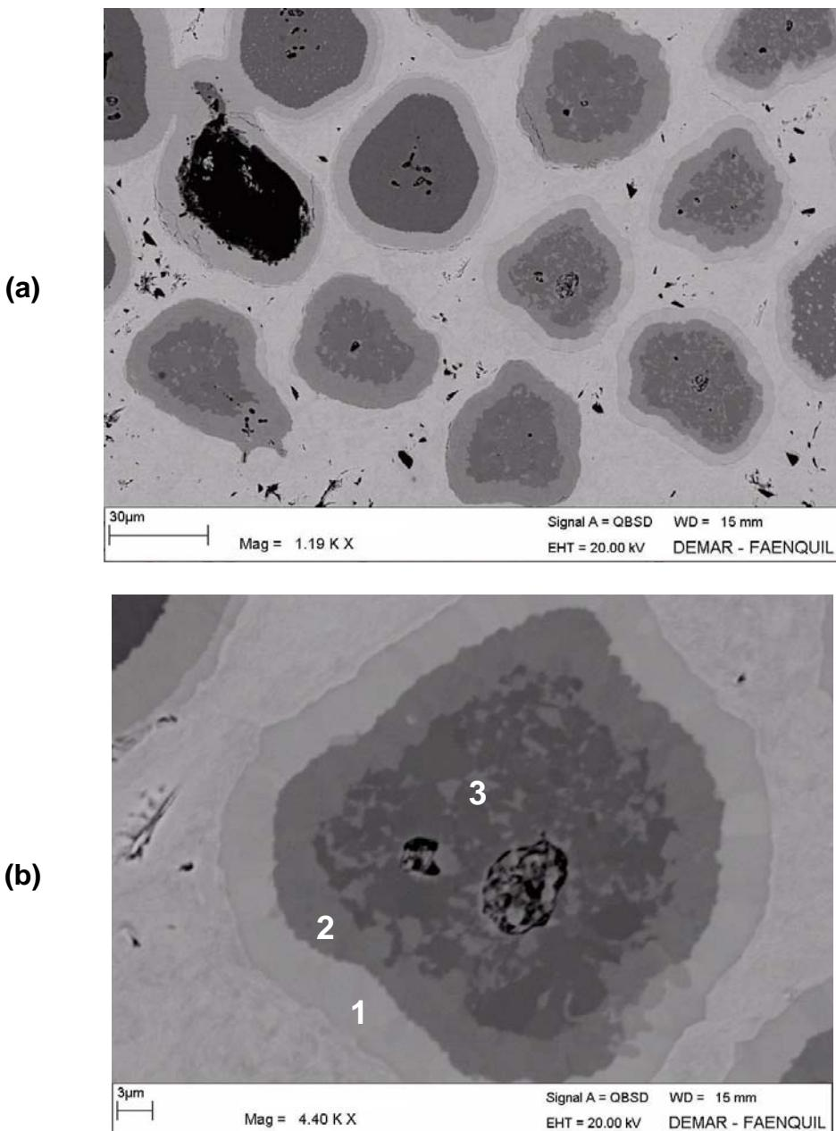
Figura 2. Micrografia obtida em MEV do primeiro embutimento após tratamento térmico a 800°C durante 200 horas: (a) região de filamentos, (b) identificação de fases relativas à Tabela I.
