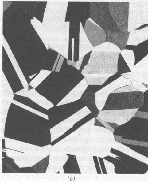
**Fig. 4.11** (a) Grãos polidos e atacados quimicamente da forma como eles aparecem quando são vistos através de um microscópio ótico. (b) Seção feita através desses grãos mostrando como as características do ataque químico e a textura da superfície resultante variam de grão para grão devido a diferenças na orientação cristalográfica. (c) Fotomicrografia de uma amostra de latão policristalino. Ampliação de 60 $\times$ . (Esta fotomicrografia é uma cortesia de J. E. Burke, General Electric Co.)
