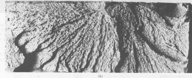
Fig. 8.5 (a) Fotografia mostrando "marcas de sargento" em forma de "V" características de uma fratura frágil. As setas indicam a origem da trinca. Aproximadamente em tamanho real. (De R. W. Hertzberg, Deformation and Fracture Mechanics of Engineering Materials , 3rd edition. Copyright © 1989 de John Wiley & Sons, New York. Reimpresso sob permissão de John Wiley & Sons, Inc. A fotografia é uma cortesia de Roger Slutter, Lehigh University.) (b) Fotografia de uma superfície de fratura frágil mostrando nervuras radiais em formato de leque. As setas indicam a origem da trinca. Aumento de aproximadamente 2X. (Reproduzido com permissão de D. J. Wolpi, Understanding How Components Fail , American Society for Metals, Materials Park, OH, 1985.)
