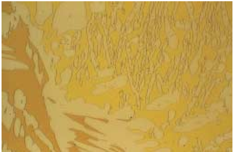
Cu58Zn42 Mag: 500x Etchant: Klemm III
