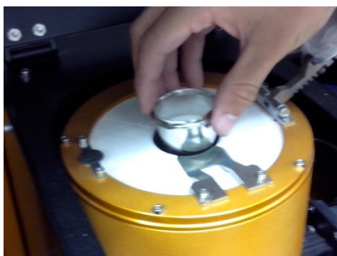
Figura 1 Encaixe do cadinho no forno
