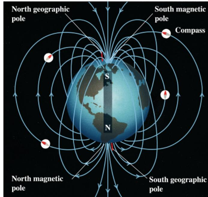
A direção do campo magnético sobre a superfície da Terra pode ser especificada em termos de dois ângulos: a *declinação* e a *inclinação* do campo.
