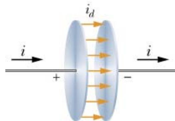
Para o caso de um capacitor sendo carregado (figura), mostra-se facilmente que  $i_d = i$ ; então podemos considerar a corrente fictícia  $i_d$  como dando continuidade à corrente real  $i$  que está carregando o capacitor.
