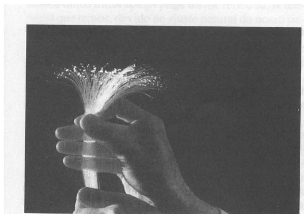
Fig. 39-7 Uma fibra ótica transmite a luz introduzida numa extremidade para a oposta, com pequena perda pelas laterais da fibra, porque a maior parte da luz sofre uma seqüência de reflexões internas totais ao longo dessas laterais.
