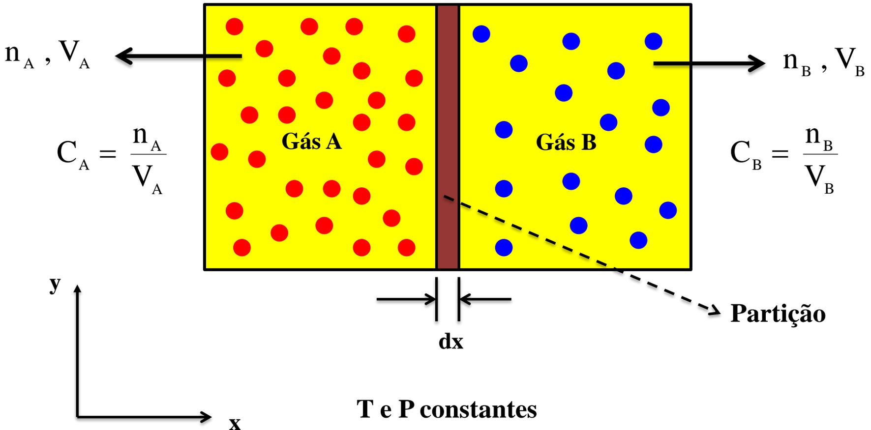
Ao retirar-se a partição, os dois gases difundem um através do outro até que a concentração de ambos seja uniforme em todo o volume “V”.
