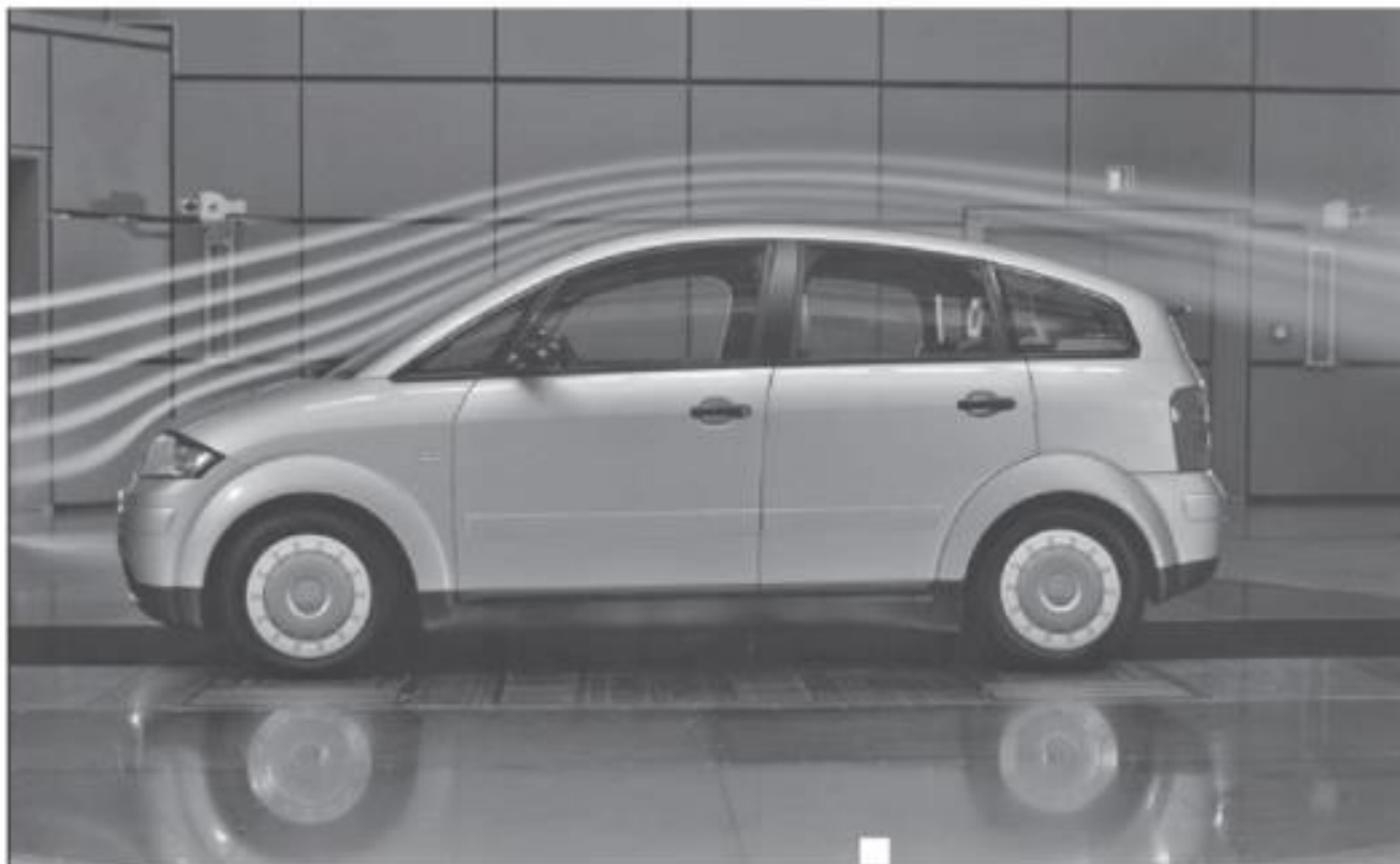
Fig. 2.4 Linhas de emissão sobre um automóvel em um túnel de vento. (Cortesia da Audi AG.)
