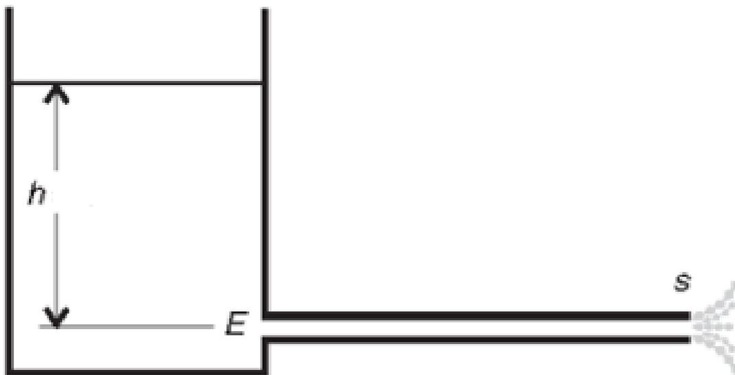
Exercício 3: Calcule o diâmetro de um tubo de aço que deverá transportar uma vazão de 19 L/s de querosene ( $\nu = 3,0 \times 10^{-6}$  m<sup>2</sup>/s) a uma distância de 600 m, com uma perda de carga de 3 m. (Solução por tentativa e erro).
