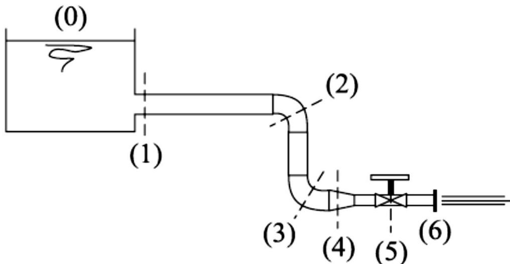
Entre (1 e 2), (2 e 3), (3 e 4), (4 e 5) e (5 e 6) existem perdas distribuídas. Em (1) estreitamento brusco, (2) e (3) cotovelos, (4) estreitamento, (5) válvula, existem perdas localizadas.
