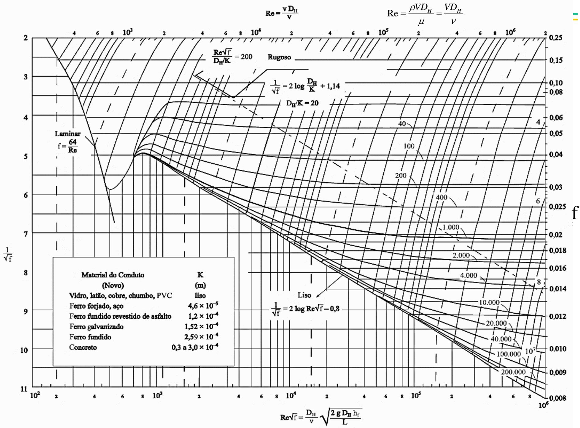
Exercício 1: Determinar a perda de carga por Km de comprimento de uma tubulação de aço de seção circular de diâmetro 45 cm. O fluido é óleo ( $\nu = 1,06 \times 10^{-5} \text{ m}^2/\text{s}$ ) e a vazão é 190 L/s.
