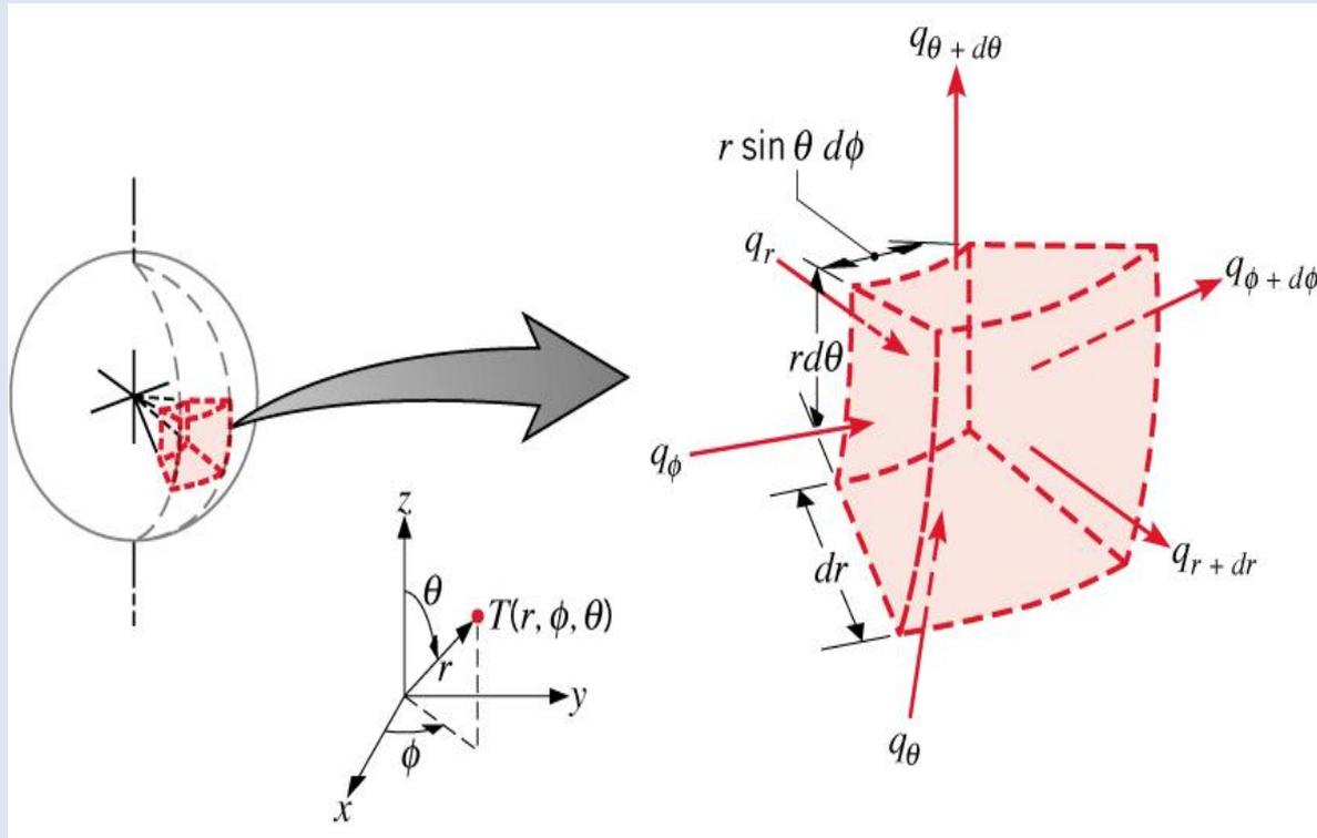
Volume de controle diferencial,  $dr \ r \sin(\theta) d\phi \ r d\theta$ , para análise de condução em coordenadas cilíndricas  $(r, \phi, \theta)$ .
