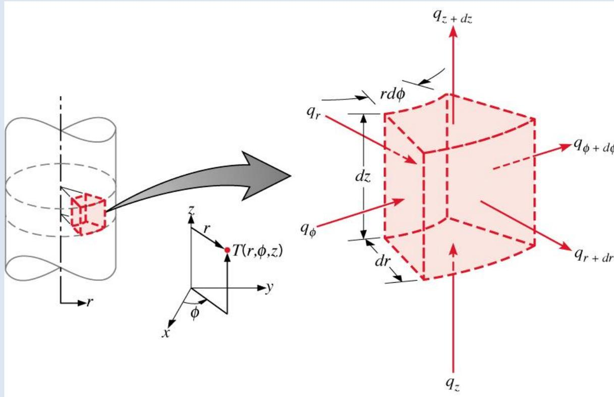
Volume de controle diferencial,  $dr \, r d\phi \, dz$ , para análise de condução em coordenadas cilíndricas ( $r, \phi, z$ ).
