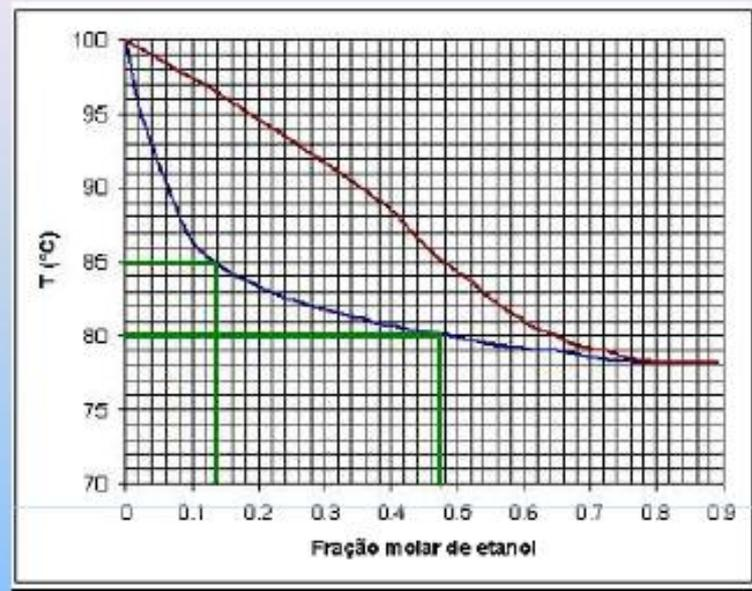
A fração molar inicial ( $x_0$ ) e no resíduo ( $x$ ) podem ser obtidas diretamente no diagrama temperatura versus composição.
