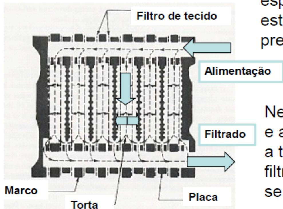
Nesse momento a armação e as placas são separadas e a torta retirada. Depois o filtro é remontado e o ciclo se repete.
