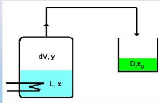
BALANÇO MATERIAL PARA UM DOS COMPONENTES
