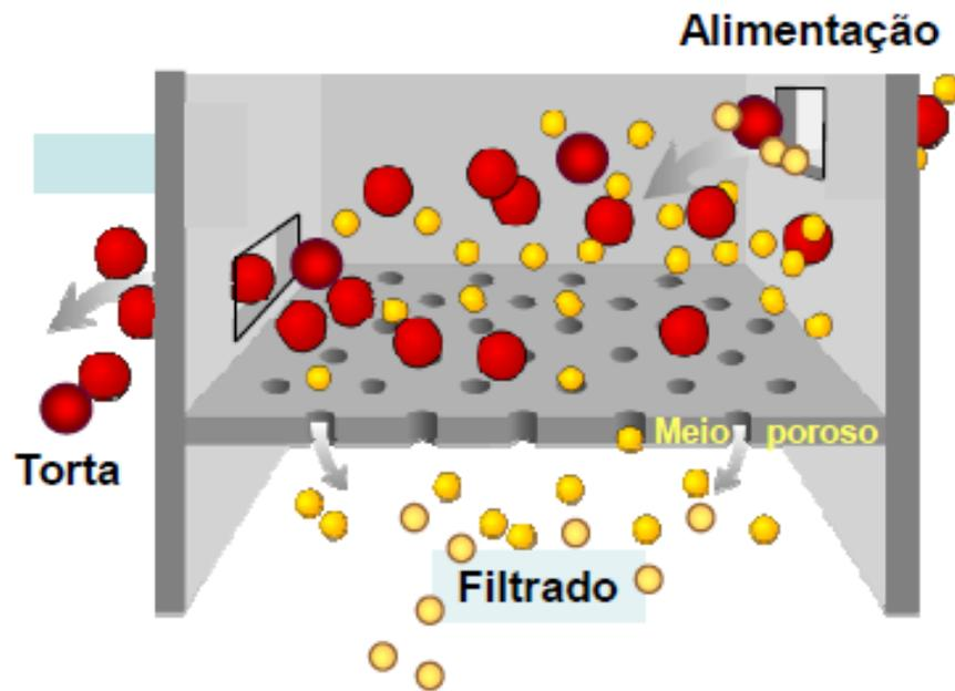
Na filtração, as partículas sólidas suspensas em um fluido são separadas usando um **meio poroso**.
