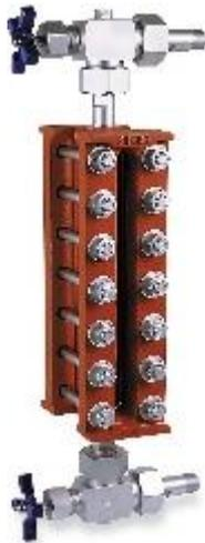
A instalação dos visores de nível é feita sempre através de válvulas de bloqueio e de dreno de forma a permitir a manutenção dos mesmos. Estão disponíveis em diversas dimensões, de 170 a 1760 mm, de acordo com a faixa de medida necessária. É possível a instalação de visores combinados em série, de modo a aumentar a faixa de medição. A classe de pressão do visor de nível evidentemente deve estar de acordo com a do vaso de processo.
