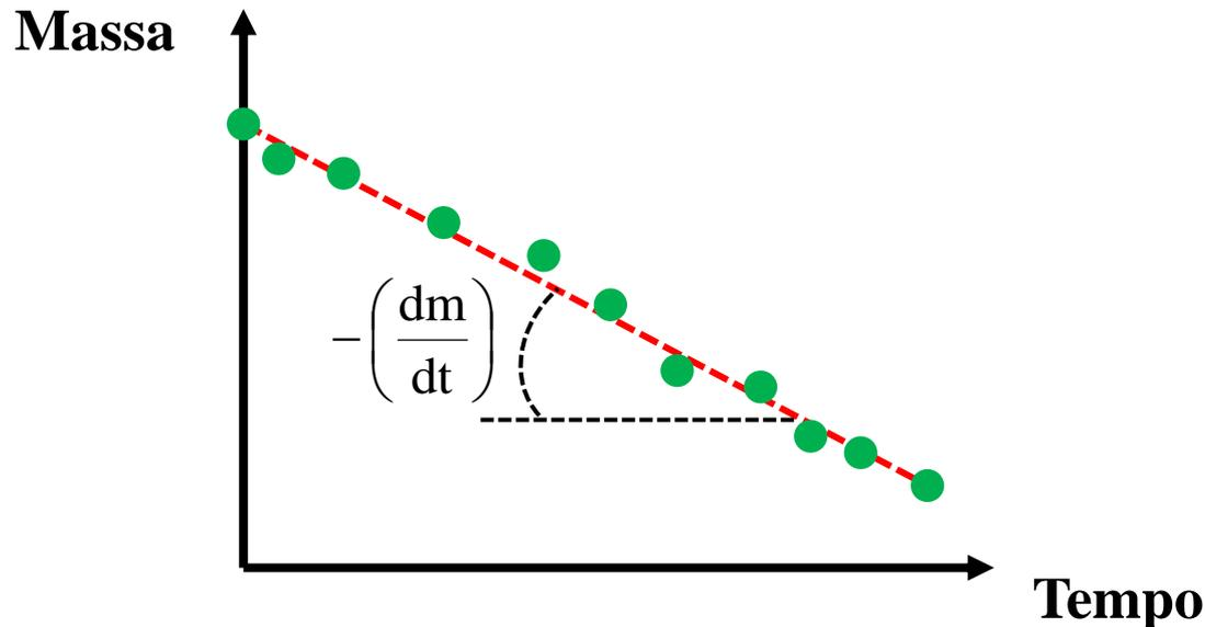
onde o sinal negativo indica o decréscimo da massa  $m$  do corpo-de-prova no tempo. Admitir somente o fluxo do soluto A na direção radial da esfera.
