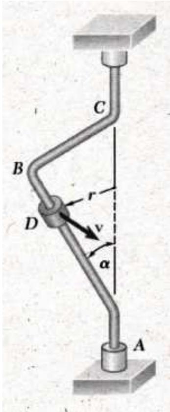
Um pequeno colar  $D$  de 300 g pode deslizar sobre a parte  $AB$  de uma haste que é curvada, tal como mostra a figura. Sabendo que  $\alpha = 40^\circ$  e que a haste gira em torno da vertical  $AC$  a uma taxa constante de 5 rad/s, determine o valor  $r$  para o qual o colar não deslizará sobre a haste se o efeito do atrito entre a haste e o colar for desprezado.
