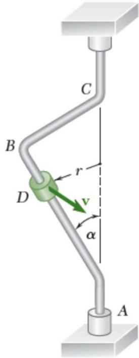
**12.56** Um pequeno colar  $D$  de 200 g pode deslizar sobre a parte  $AB$  de uma haste que é curvada, tal como mostra a figura. Sabendo que a haste gira em torno da vertical  $AC$  a uma taxa constante e que  $\alpha = 30^\circ$  e  $r = 600$  mm, determine o intervalo de valores da velocidade  $v$  para qual o colar não deslizará sobre a haste se o coeficiente de atrito estático entre a haste e o colar é 0,30.
