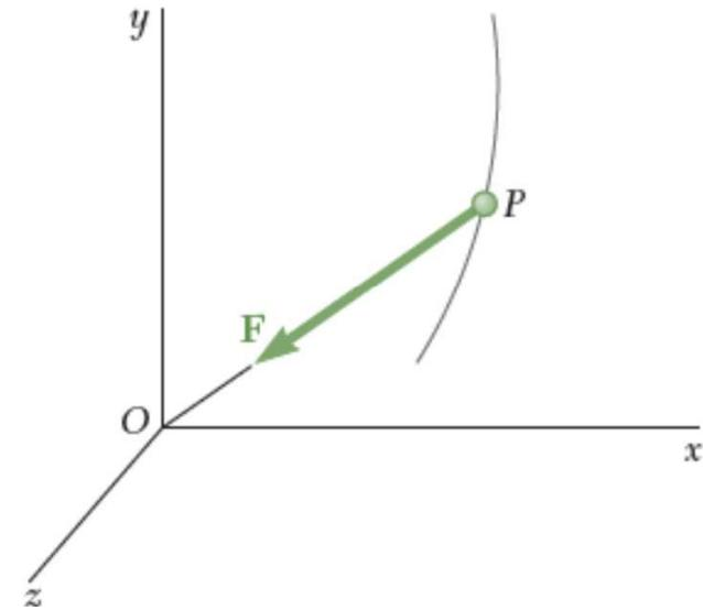
Quando a única força que atua sobre uma partícula  $P$  é uma força  $\mathbf{F}$  dirigida para, ou afastando-se de, um ponto fixo  $O$ , diz-se que essa partícula se move sob a *ação de uma força central* e o ponto  $O$  é chamado de *centro de força* (Fig. 12.15). Como a linha de ação de  $\mathbf{F}$  passa por  $O$ , devemos ter  $\Sigma \mathbf{M}_O = 0$  em qualquer instante dado. Substituindo na Eq. (12.19), obtemos, portanto
