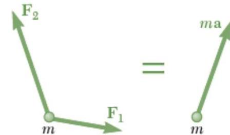
**Componentes retangulares.** Decompondo cada força  $\mathbf{F}$  e a aceleração  $\mathbf{a}$  em componentes retangulares, escrevemos
