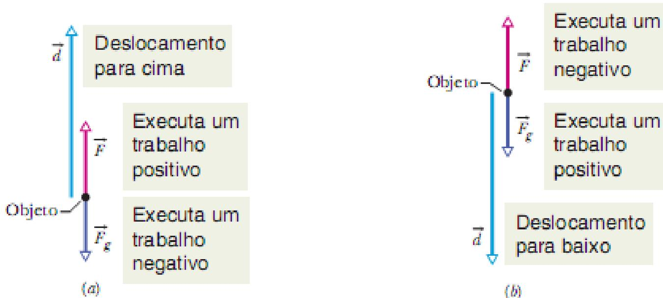
(a) A força aplicada é maior que a força gravitacional. O deslocamento do objeto faz um ângulo  $\phi = 180^\circ$  com a força gravitacional. A força gravitacional realiza um trabalho negativo.
