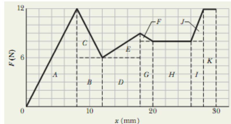
**Cálculos** Como nosso gráfico é formado por segmentos de reta, podemos calcular a área separando a região sob a curva em regiões retangulares e triangulares, como na Fig. 7-12b. A área da região triangular A, por exemplo, é dada por
