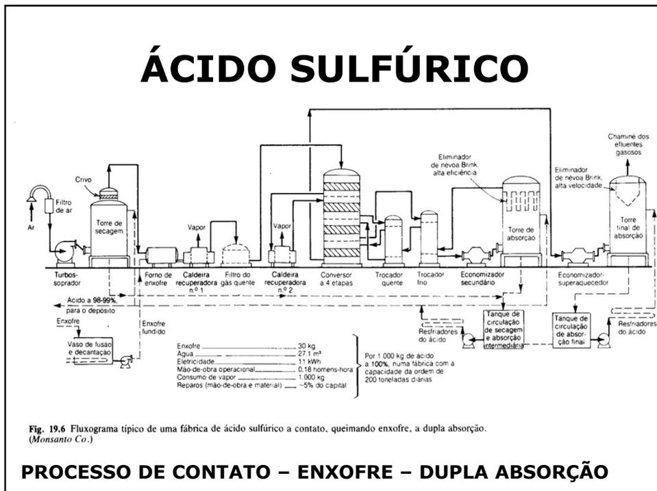
Fig. 19.6 Fluxograma típico de uma fábrica de ácido sulfúrico a contato, queimando enxofre, a dupla absorção. (Monsanto Co.)
