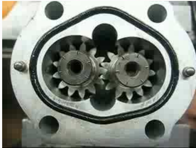
BOMBA DE ENGRENAGENS
