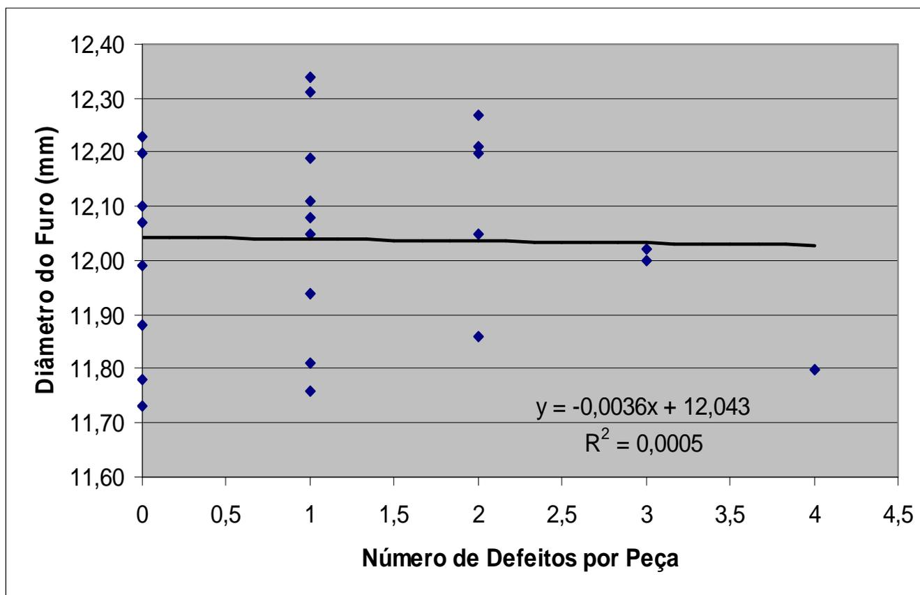
**NÃO EXISTE EVIDÊNCIA DE CORRELAÇÃO ENTRE O DIÂMETRO DO FURO E O NÚMERO DE DEFEITOS POR PEÇA**
