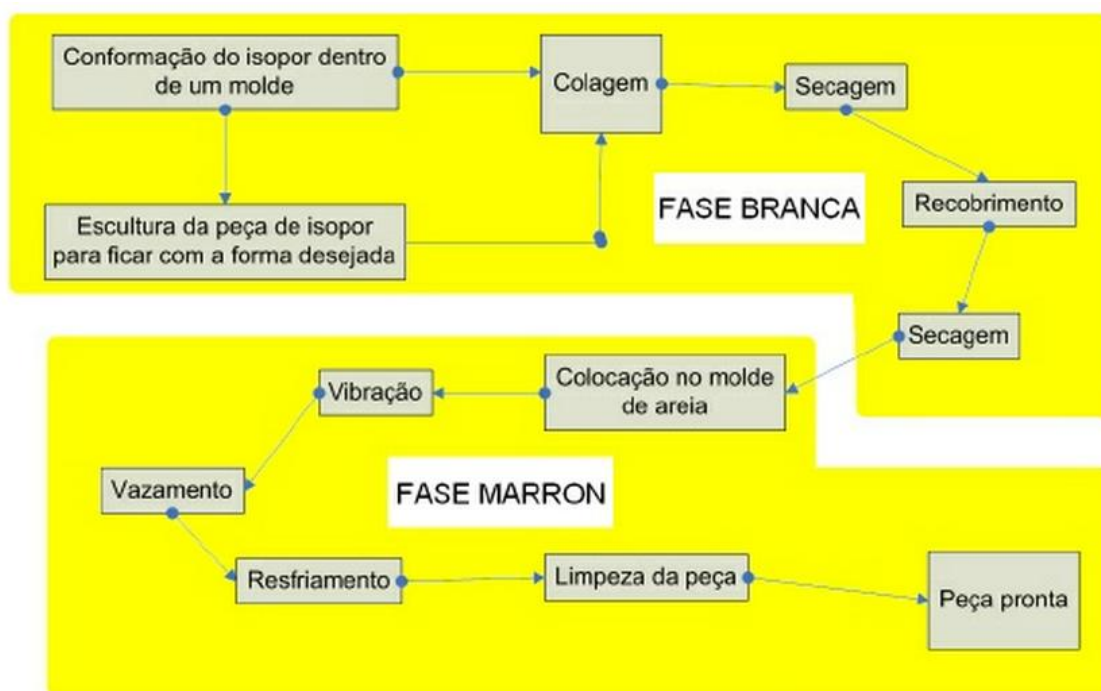
Figura 1- Fluxograma referente ao processo de fundição por molde cheio.
