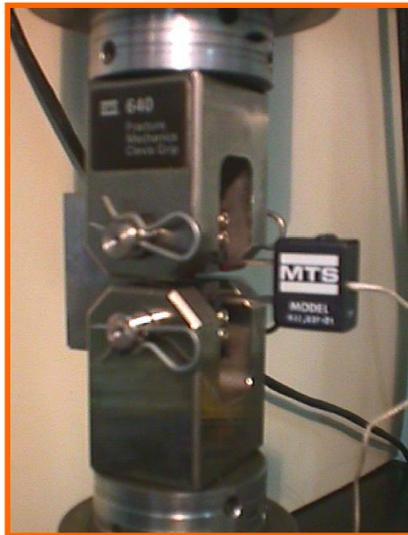
*Corpo-de-prova com medidor de COD ("clip gage") posicionado*
