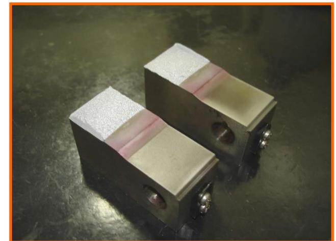
*Corpo-de-prova após ensaio de Tenacidade à Fratura (ASTM E399)*
