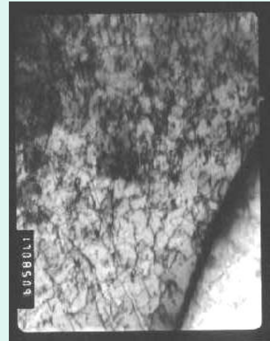
Grão ferrítico em aço bifásico após 8% da vida esperada em fadiga
