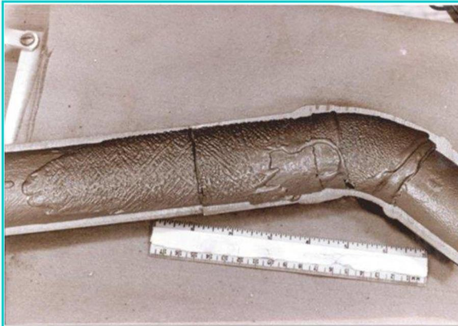
*Corrosão-erosão por CO<sub>2</sub>
