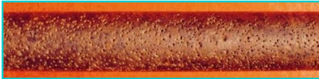
*Corrosão por pites em tubo de aço inoxidável 304*
