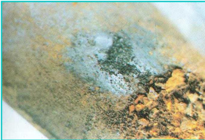
*Corrosão seletiva do ferro fundido*
