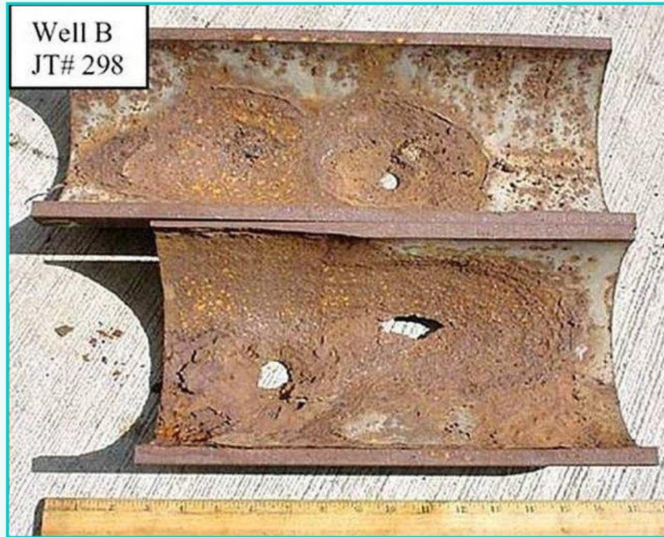
Falha em tubulação (diâmetro 7 polegadas) de uma coluna de produção de poço de gás (contendo  $\text{CO}_2$  e  $\text{H}_2\text{S}$ ), devido à corrosão. O custo de retirada e substituição de uma coluna em um poço típico *on-shore* é da ordem de US\$ 2 milhões, além do custo de produção cessante.
