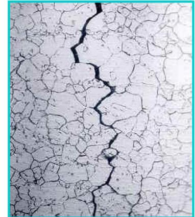
*Corrosão sob tensão com crescimento de trinca intergranular em Inconel (500x).*
