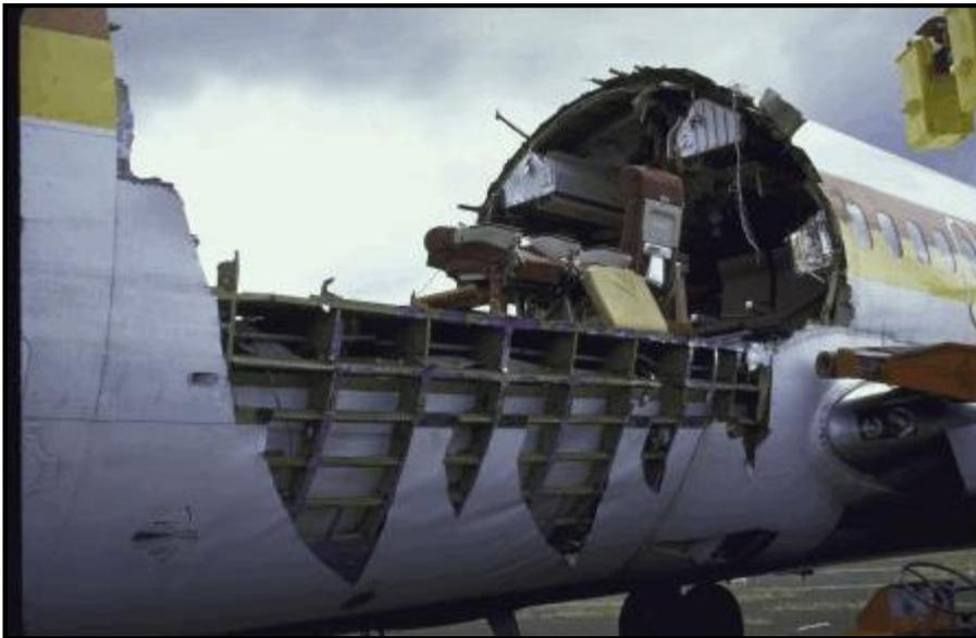
**Causa: trincas iniciadas por corrosão-fadiga cresceram por fadiga até atingirem tamanho crítico, resultando em falha catastrófica.**
