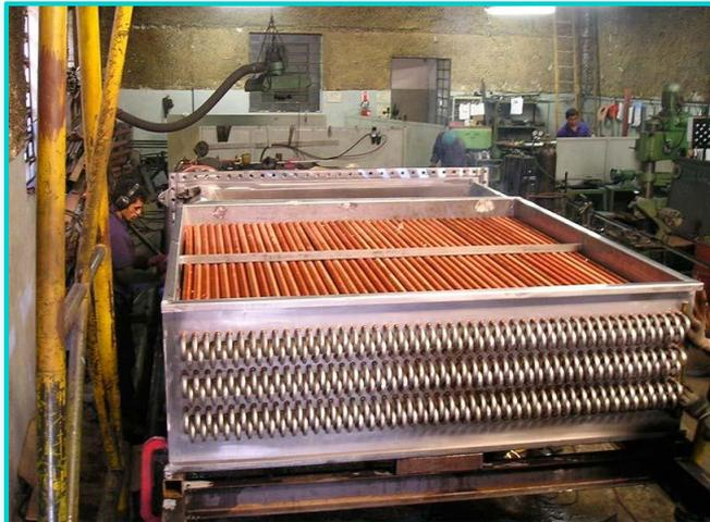
*Radiador de cobre industrial (tipo de trocador de calor destinado à troca térmica entre um gás, geralmente o ar, e outro fluido, líquido ou gasoso)*
