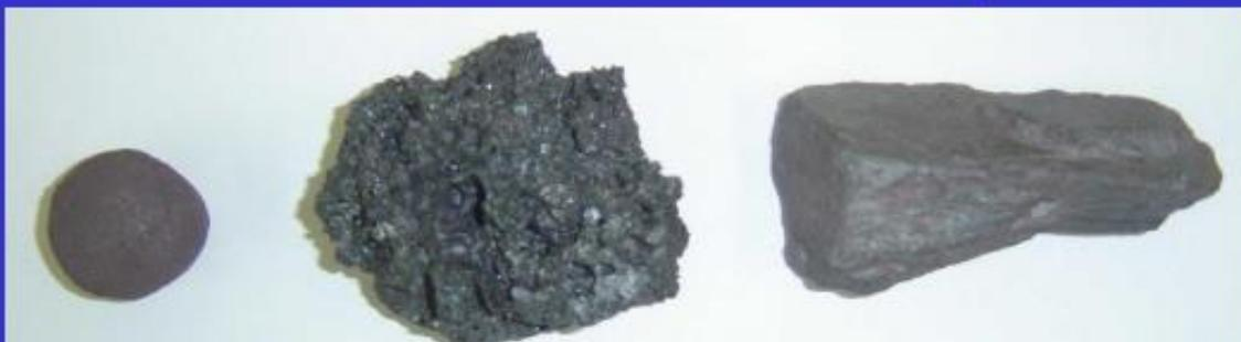
*Pelotas, sinter e minério granulado são inseridos no alto-forno*
