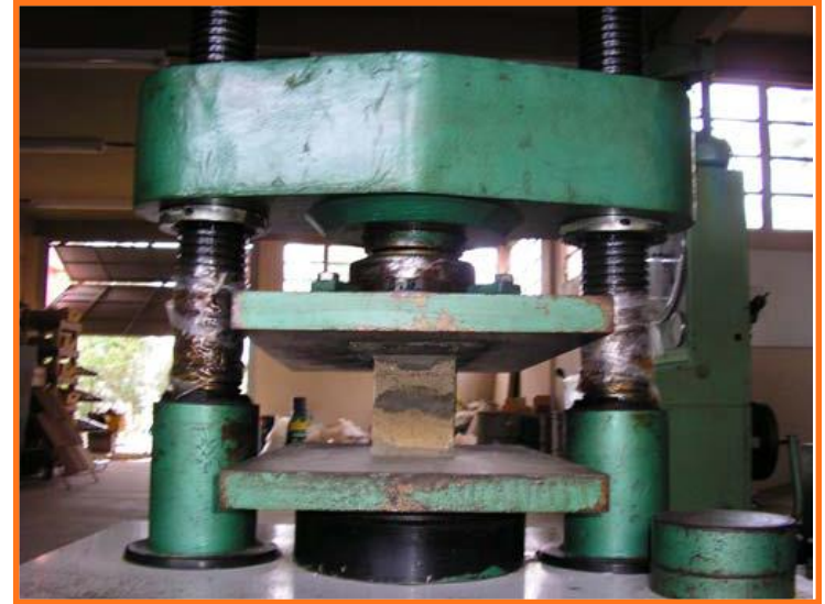
Tijolo preparado, ensaio de compressão axial
