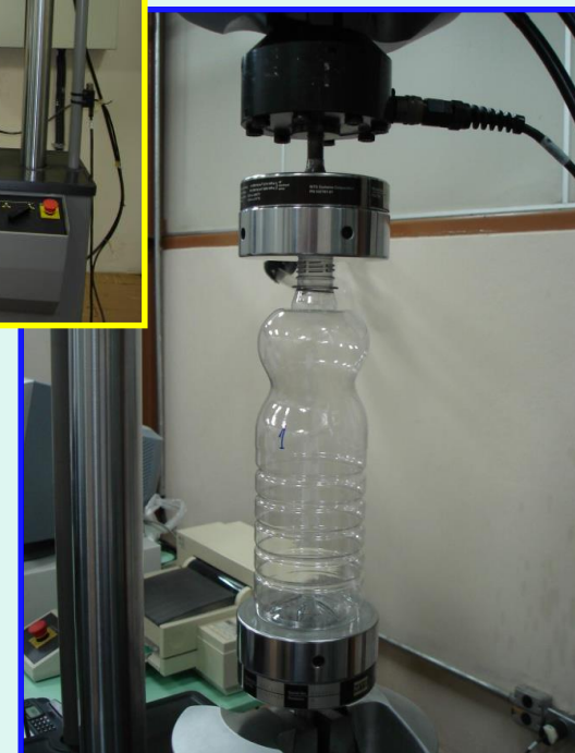
Ensaio de compressão em garrafas plásticas
