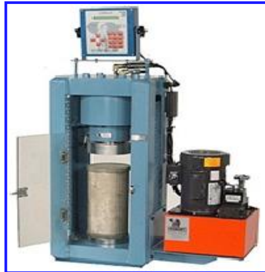
Ensaio de compressão em corpo-de-prova de concreto
