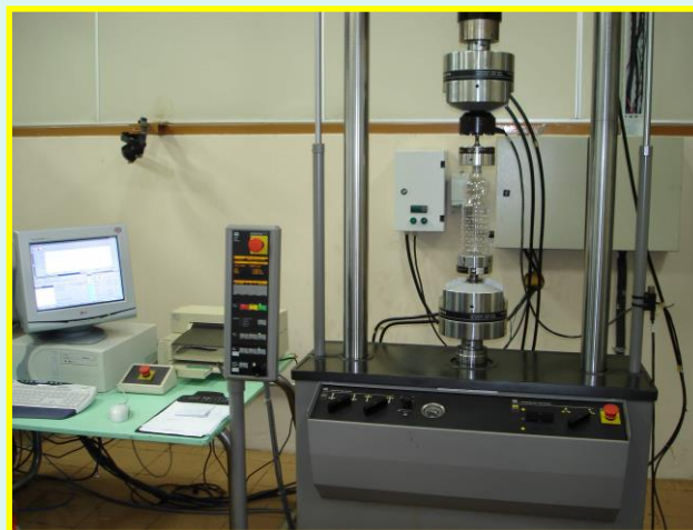
Ensaio de compressão em garrafas plásticas
