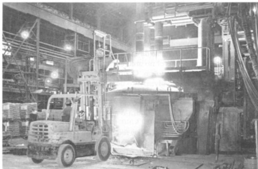
Fig. 8.8 - Forno elétrico a arco [vista pelo lado da porta].
