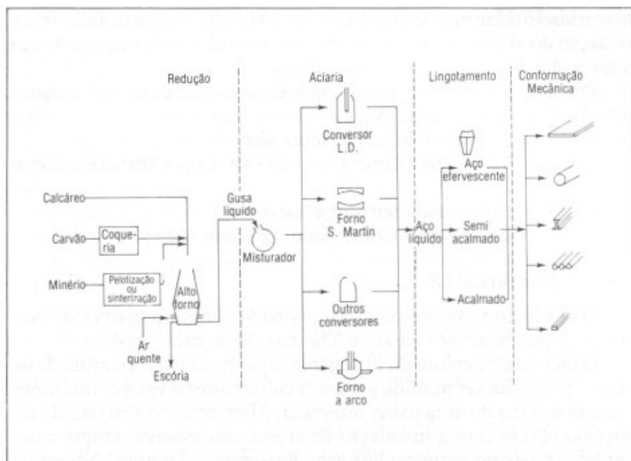
Fig. 8.4 - Fluxograma de uma usina integrada.
