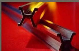
Barra metálica de platina-irídio
