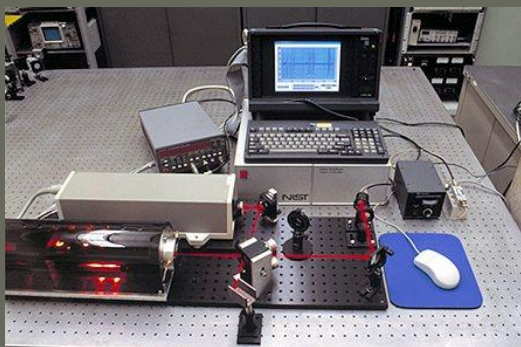
Laser de hélio-neon estabilizado por vapor de iodo
