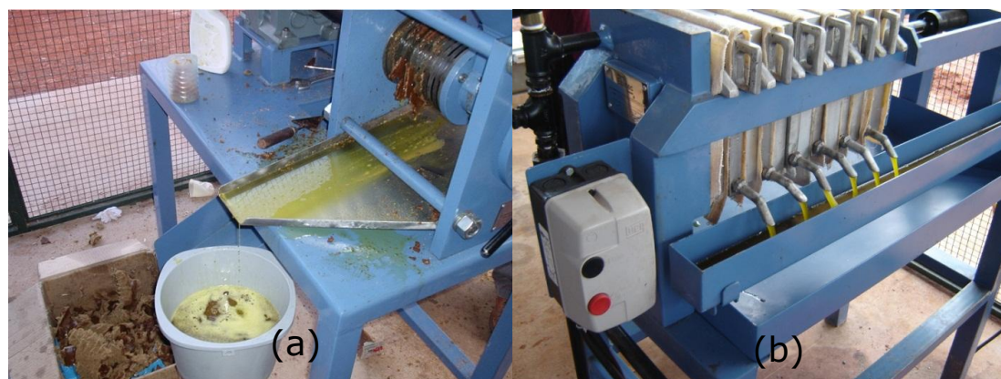
Figura 9. Extração de óleo de sementes ou frutos por prensagem em prensa contínua (a) e filtragem do óleo obtido em filtro-prensa (b). Foto de Paulo A. Z. Suarez
