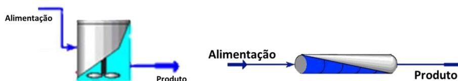
Os reatores contínuos apresentam fluxo de saída igual ao de entrada, assim que atingem o estado estacionário. No CSTR (reator contínuo de mistura perfeita) a composição química é a mesma dentro do reator e no fluxo de saída. Já no PFR (reator tubular de fluxo pistonado) a composição química muda ao longo do reator (FOGLER, 1999).
