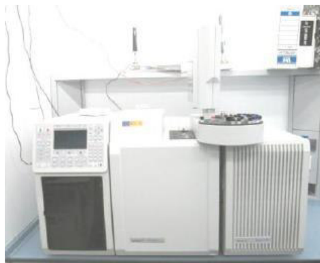
Figura 22 - Cromatógrafo gasoso utilizado para análise qualitativa dos ácidos graxos presentes na amostra.
