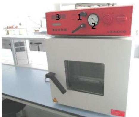
Figura 16- Forno à vácuo. 1 – Válvula de vácuo; 2 – Controle de vácuo; 3 – Controle de temperatura
