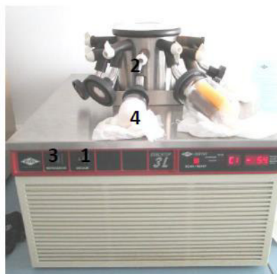
Figura 17 - Liofilizador VIRTIS (1 – Botão de vácuo; 2 – Válvula de vácuo; 3 – Controle de temperatura; 4 – Papel de segurança)
