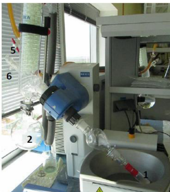
Figura 20 - – Concentrador de soluções (1 – Amostra a concentrar; 2 – Coletor de solvente; 3 – Sistema de aquecimento; 4 – Sistema de agitação; 5 – Válvulas de vácuo; 6 – Refrigerante)
