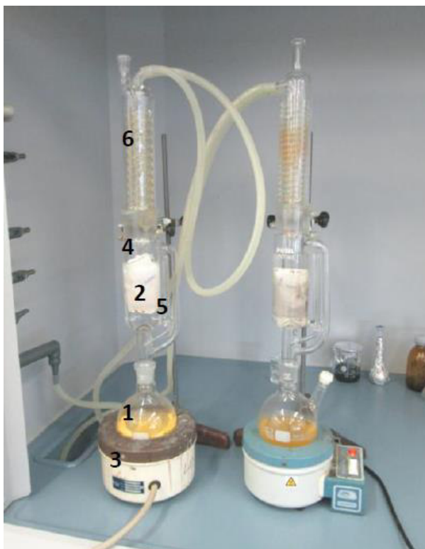
Figura 19 - Extrator Soxhlet (1 – Balão com solvente e extrato; 2 – Cartucho de papel com a amostra sólida; 3 – Manta aquecedora; 4 – Câmara de extração; 5 – Sifão; 6 – Condensador)
