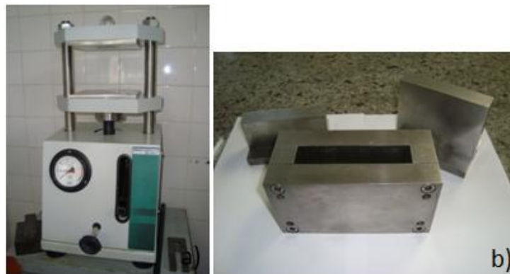
Figura 5. a) Prensa hidráulica e b) Matriz
