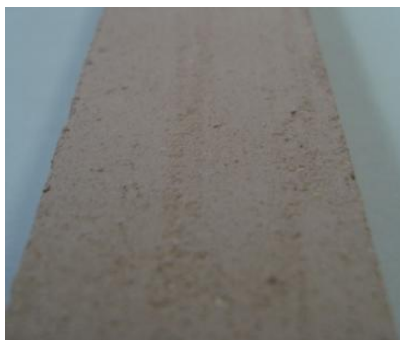
Figura 12. Superfície da amostra sinterizada na temperatura de 1100°C.
