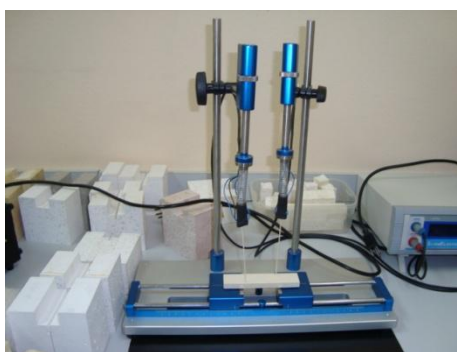
Figura 8. Equipamento usado para medir o módulo de elasticidade dos corpos de prova.
