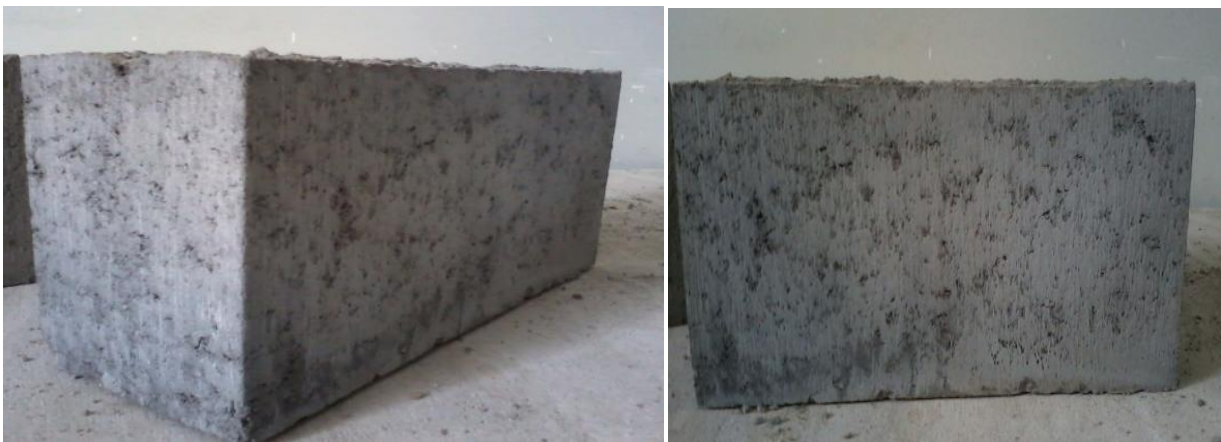
Figura 7: Fotografia de blocos de concreto produzidos com brita 0: traço 2
