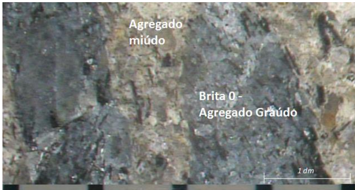
Figura 10: Fotografia obtida por microscópio estereoscópico– Traço 2 ( brita 0)
