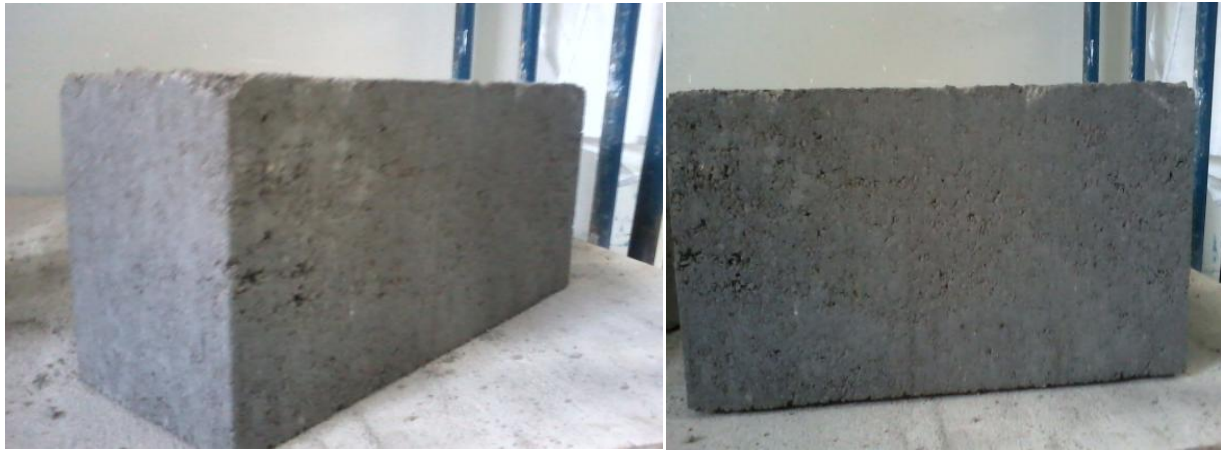
Figura 8: Fotografia de blocos de concreto produzidos com Brita 0 com menos água: traço 3
