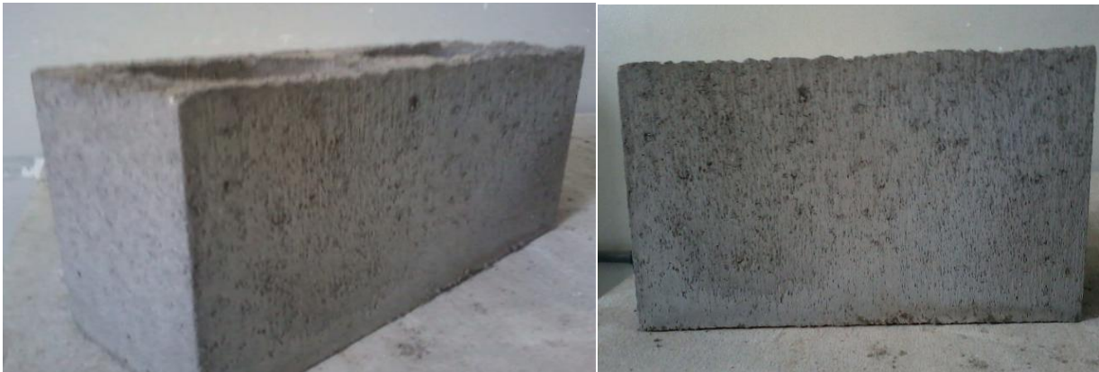
Figura 6: Fotografia de blocos de concreto produzidos com seixo rolado: traço 1
