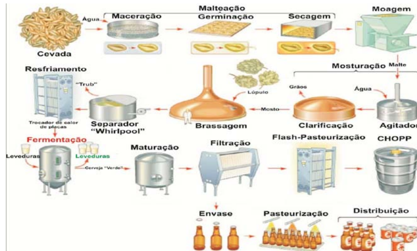
Figura 1: Fluxograma do processo cervejeiro (ENCICLOPÉDIA BARSA, 1974).
