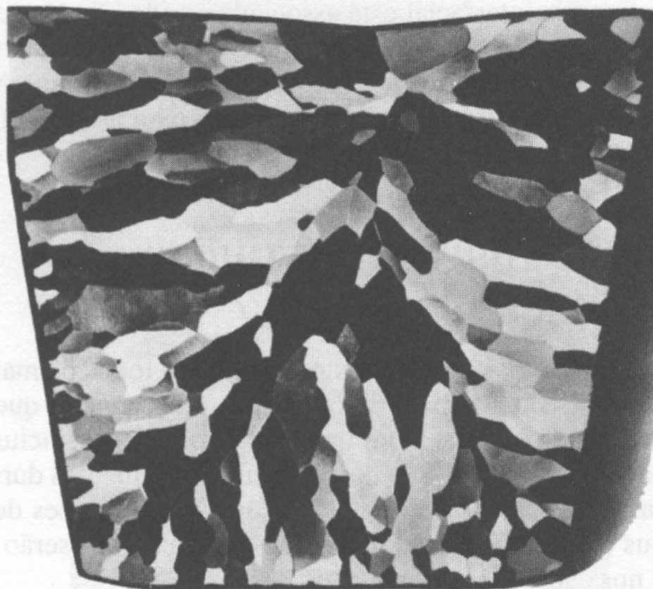
Fig. 4.10 Um lingote de chumbo policristalino de elevada pureza, onde os grãos individuais podem ser identificados. Ampliação de 0,7\times . (Reproduzido com permissão do Metals Handbook , Vol. 9, 9th edition, Metallography and Microstructures , American Society for Metals, Metals Park, OH, 1985.)
