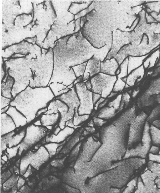
Fig. 4.6 Uma micrografia eletrônica de transmissão de uma liga de titânio na qual as linhas escuras são discordâncias. Ampliação de 51.450\times . (Cortesia de M. R. Plichta, Michigan Technological University.)
