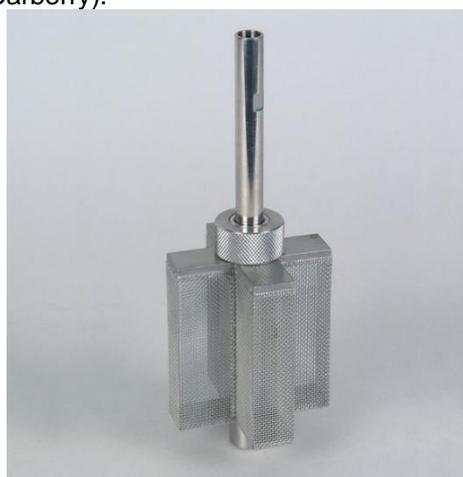
O CSTR com recirculação interna (modelo Berty) contém, em seu interior, um leito fixo de partículas de catalisador e um rotor que permite a recirculação
