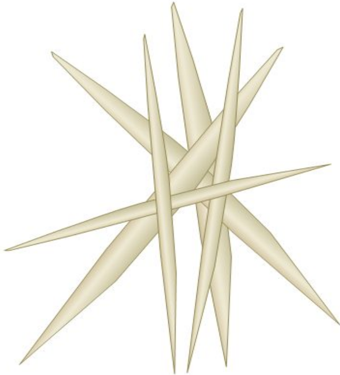
Rede de fibras não refinadas (fraca ligação)
