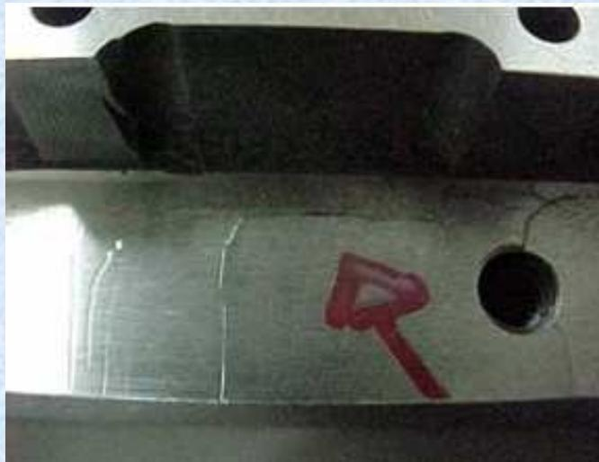
Fig 11. : exemplo de trinca causada por retífica. Aço: AISI O1 temperado para 58/60 HRC. (fonte: BRASIMET)
