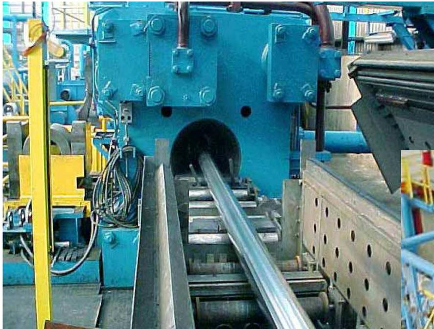
PRENSA HIDRÁULICA HORIZONTAL
