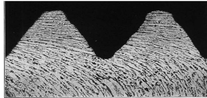
— Filetes de rosca de porca. Nota-se, pela deformação da textura a'inhada que o furo central da porca foi estampado (da direita para a esquerda) e depois se processou o corte dos filetes com macho. Ataque: nítrico. 23 x.
