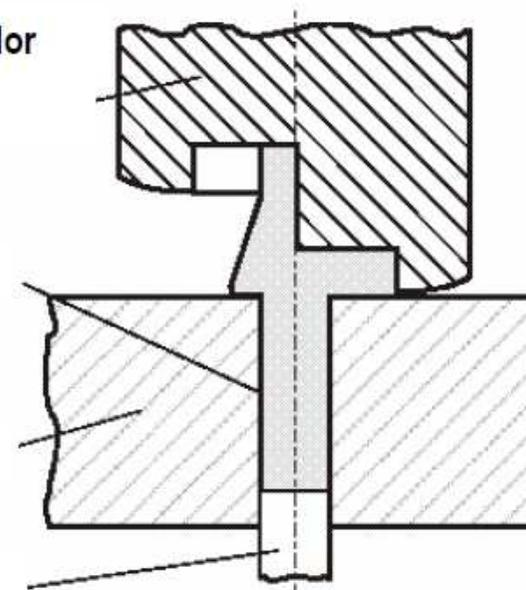
Processo de recalque duplo (pré-recalque e recalque final)
