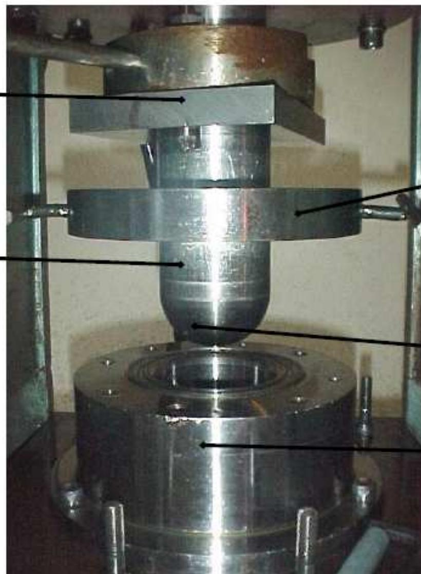
Figura 4.2 – Ferramenta utilizada no ensaio de Nakajima.
