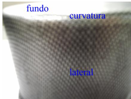
Figura 17: peça estampada no formato de um copo, indicando: fundo; curvatura entre lateral e fundo e lateral.
