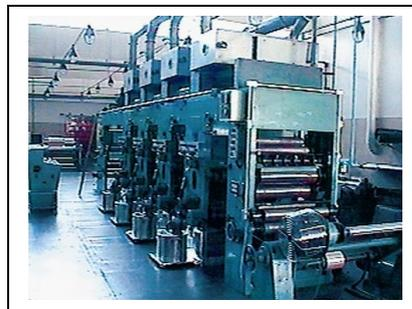
**Figura 7:** Equipamento gráfico para roto-gravura<sup>(10)</sup>
