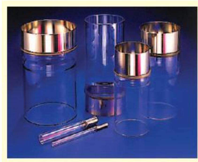
**Fotografia mostrando produtos tubulares que têm junção vidro-metal. O coeficiente de expansão térmica da liga metálica (Kovar) que tem o mesmo coeficiente de expansão térmica do vidro pirex. Como os coeficientes de expansão térmica são próximos, minimiza-se fraturas devido a tensões térmicas.**
