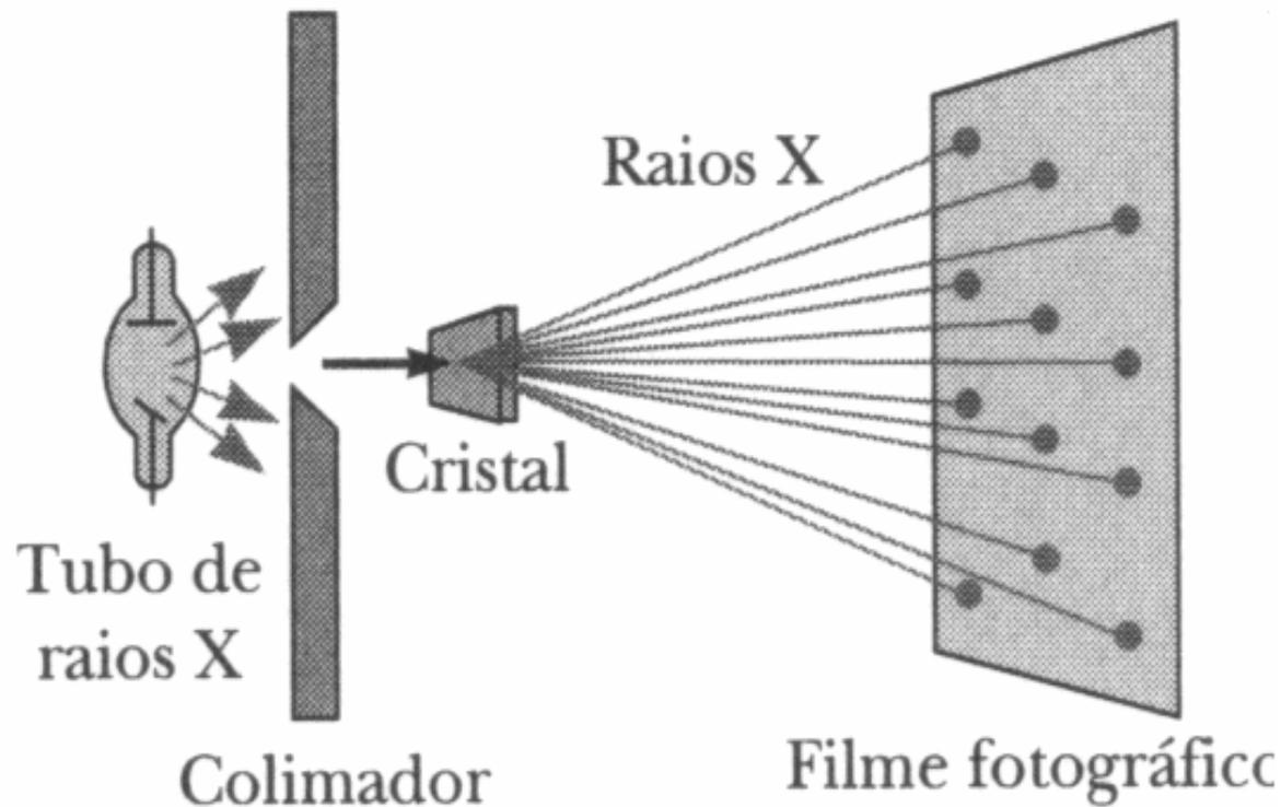
O comprimento de onda dos Raios X é da ordem do espaçamento atômico em cristais,  $10^{-10} \text{ m} = 1 \text{ \AA}$ .
