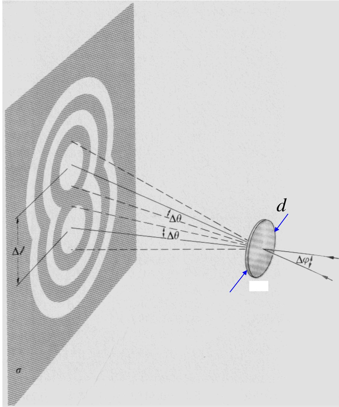
**Critério de Rayleigh** : A separação angular mínima para que duas fontes pontuais possam ser distinguidas é aquela onde o máximo central de uma coincide com o primeiro mínimo da figura de difração da outra:
