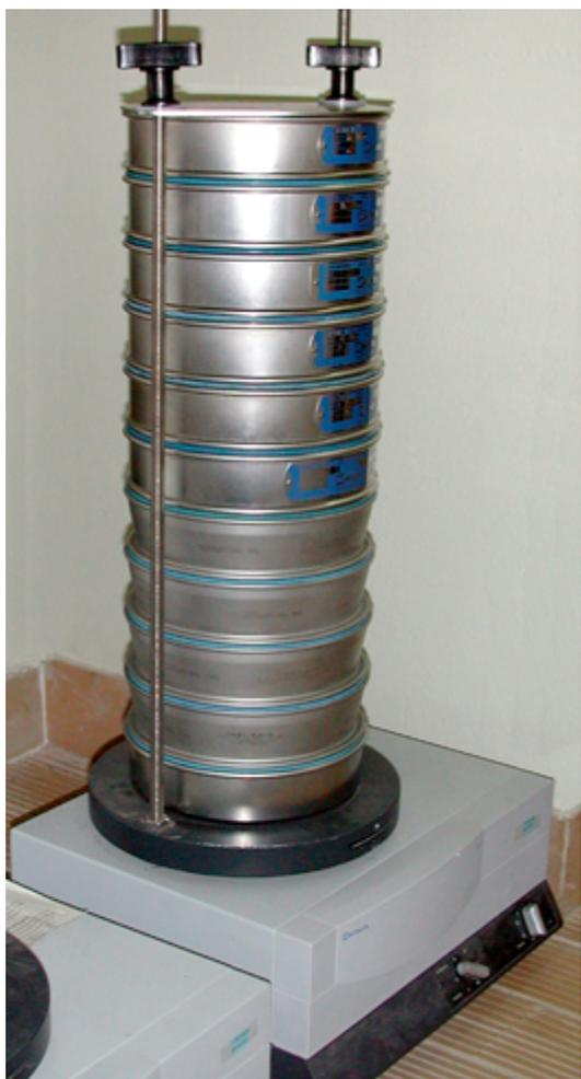
Fig. 15 - Agitador de peneiros e coluna de peneiração utilizados no CIACOMAR (Univ. Algarve).
