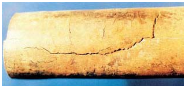
FIGURA 19: TUBO DE LATÃO QUE SOFREU PROCESSO DE CORROSÃO POR TENSÃO FRATURANTE, APÓS ENTRAR EM CONTATO COM AMÔNIA 12 .
