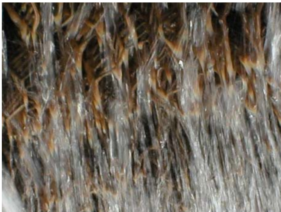
FIGURA 23: CRESCIMENTO EXAGERADO DE ORGANISMOS EM UM RECHEIO DE TORRE DE RESFRIAMENTO.
