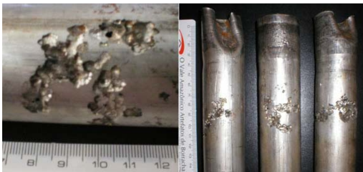
FIGURA 27: TUBOS DE AÇO INOX QUE SOFREU PROCESSO DE CORROSÃO POR BACTÉRIAS REDUTORAS DE SULFATO (GÊNERO DESSULFOVIBRIO ). OS DEPÓSITOS DE COR NEGRA SÃO COMPOSTOS POR SULFETO DE FERRO, PRODUTO DA CORROSÃO.
