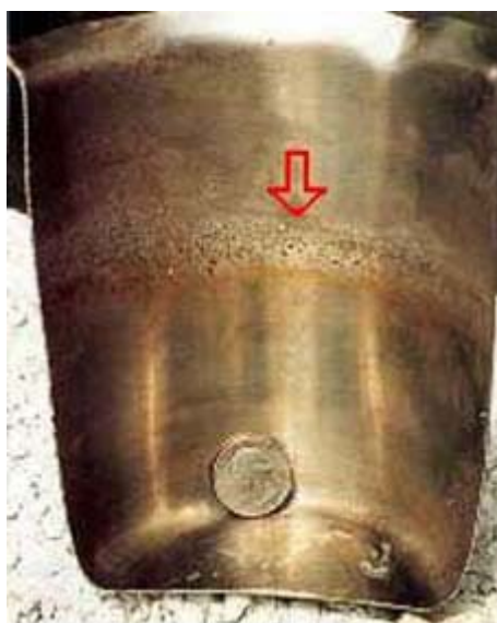
FIGURA 17: VASILHAME DE AÇO INOX, QUE CONTEVE UM BIOCIDA CLORADO DURANTE CERCA DE 3 DIAS. OBSERVE AS PERFURAÇÕES EXISTENTES NA REGIÃO DO NÍVEL DA SOLUÇÃO (SETA). ESTUDOS MOSTRAM QUE A TAXA DE PENETRAÇÃO DOS PITTINGS NESTE CASO FOI DE, APROXIMADAMENTE, 11 CM POR ANO 9 .
